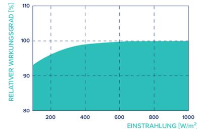
Typische Modulleistung unter niedrigen Einstrahlungsbedingungen im Vergleich zu STC-Bedingungen (25 °C, 1000 W/m<sup>2</sup>)
